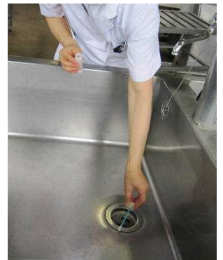
洗浄後のシンク排水口周囲の検査
