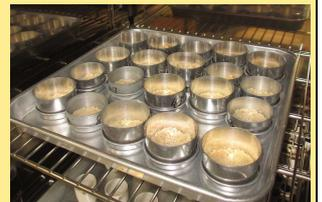
全量粉碎し、均一化されたパンを135℃の恒温器の中に1時間入れ乾燥されます。乾燥前と乾燥後の重量の差をもとに、水分値を算出します。
