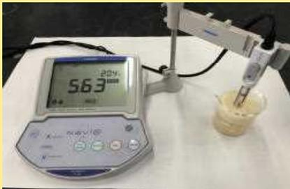
全量粉碎し、均一化されたパンに水を加え、pHメーターにより酸・アルカリ性の度合いを測定する検査を行います。
