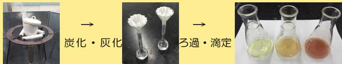
全量粉碎し、均一化されたパンを完全燃焼し灰化します。その後残留物をろ過・定容し、一定量を三角フラスコに採取、硝酸銀溶液で滴定し、色が変わった溶液量から塩分値を算出します。
