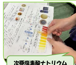
次亜塩素酸ナトリウム 溶液の濃度検査
